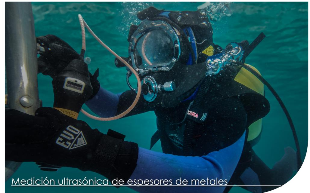
Medición ultrasónica de espesores de metales
